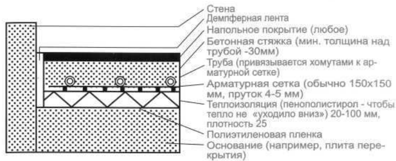
Рис.4.6. Конструкция греющего пола (бетонная система).
